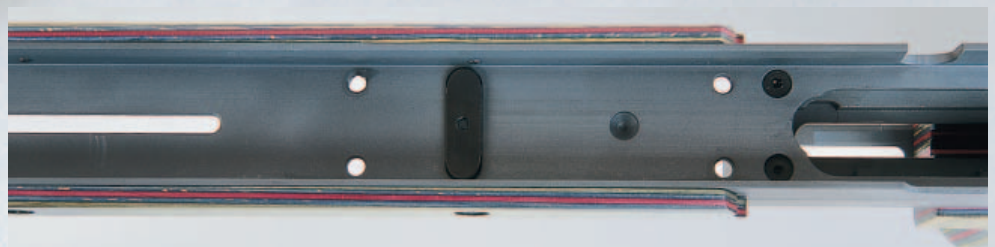
Blick in den Vorderschaft: Der Rückstoßstollen im Schaft greift über eine Nut in die Hülse.
