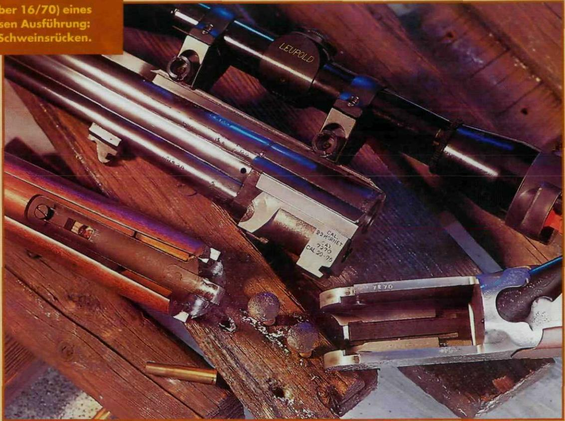
**Die Sabatti BBF aus Italien kombiniert eine .22 Hornet mit einem Schrotlauf im Kaliber 20/76 Magnum. Die deutlichen Spuren, die der Fräskopf im Metall hinterließ, trüben den guten Gesamteindruck etwas. Die Waffe verfügt über einen soliden Keilverschluß (oben). Mit dem ZF Leupold, Vergrößerung 12 x 42, eine ideale Schonzeitwaffe.**
